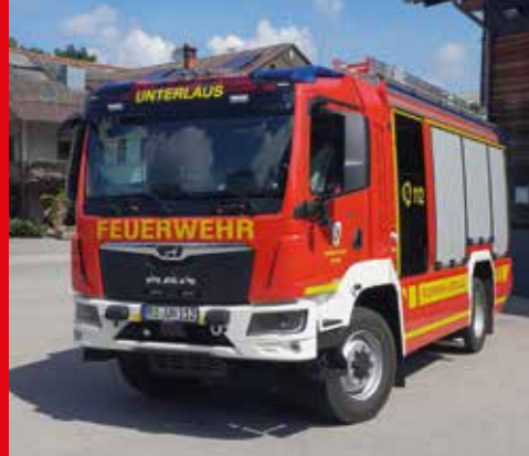
FF Unterlaus LF 10 Fahrgestell MAN TGM 16.320 4x4 Aufbau Rosenbauer AT
