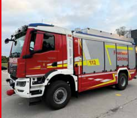
FF Gilching RW Fahrgestell MAN TGM 18.320 4x4 Aufbau Rosenbauer AT
