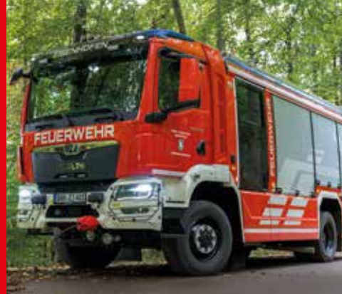
FF Eisenhofen HLF 20 Fahrgestell MAN TGM 16.320 4x4 Aufbau Rosenbauer AT
