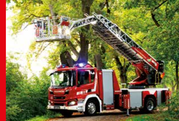
FF Oberaltling-Seefeld DLK 23/12 L32A-XS Fahrgestell Scania P280 4x2 Aufbau Rosenbauer
