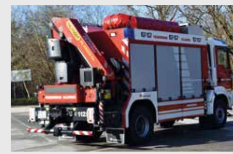
FF Olching, RW Kran Fahrgestell: MAN TGM 18.340 4x4 Aufbau: ROSENBAUER
