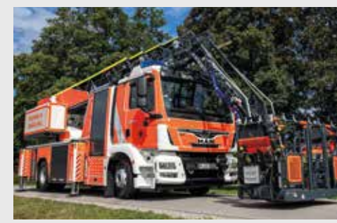
FF Gräfelfing, DLAK 23/12 L32A-XS 3.0 Fahrgestell: MAN TGM 15.290 4x2 Aufbau: ROSENBAUER
