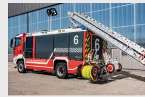
Werkfeuerwehr Sonderflughafen EDMO Fahrgestell: MAN TGM 18.320 4x4 Aufbau: ROSENBAUER AT, HLF 20
