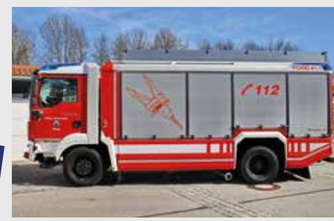
FF Poing, RW Fahrgestell: MAN TGM 15.290 4x4 Aufbau: ROSENBAUER AT
