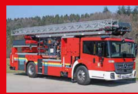
WFTU Weihenstephan, HRB 32 Fahrgestell: Mercedes Econic 1830 Aufbau: Rosenbauer
