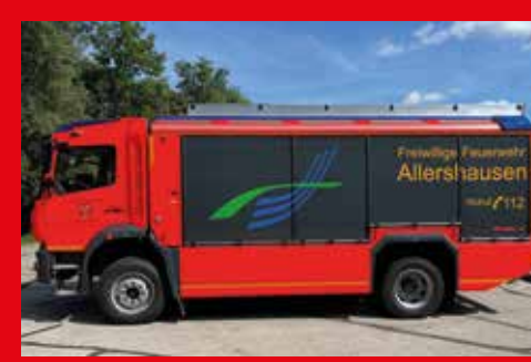
FF Allershausen RW Fahrgestell: Mercedes Atego 1530 F 4x4 Aufbau: Rosenbauer AT
