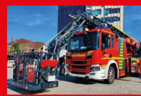
FF Maisach, DLK 23/12 L32A - XS 3.0 Fahrgestell: SCANIA P280 Aufbau: Rosenbauer
