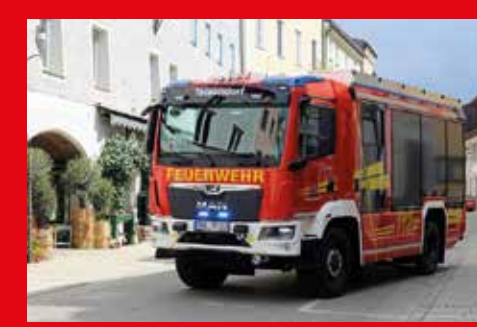
FF Teisendorf TLF 3000 - Staffel Fahrgestell: MAN TGM 13.320 BL 4x4 Aufbau: Rosenbauer AT
