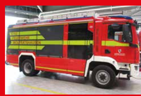
FF Wolfratshausen HLF 20 Fahrgestell: MAN TGM 13.320 4x4 Aufbau: Rosenbauer AT
